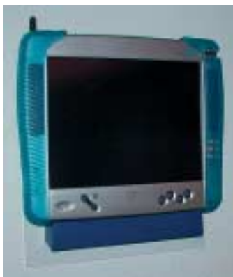
Bild 7: Eines der 13 Webpads für die mobile Bedienung der Technik. Quelle: Bus-House
