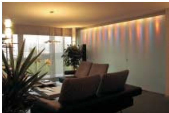
Bild 4: Die Glaswand zwischen Wohn- und Esszimmer wird durch eine Halogenreihe beleuchtet, die beim Dimmen ihr Farbenspektrum verändert. Quelle: ABB
